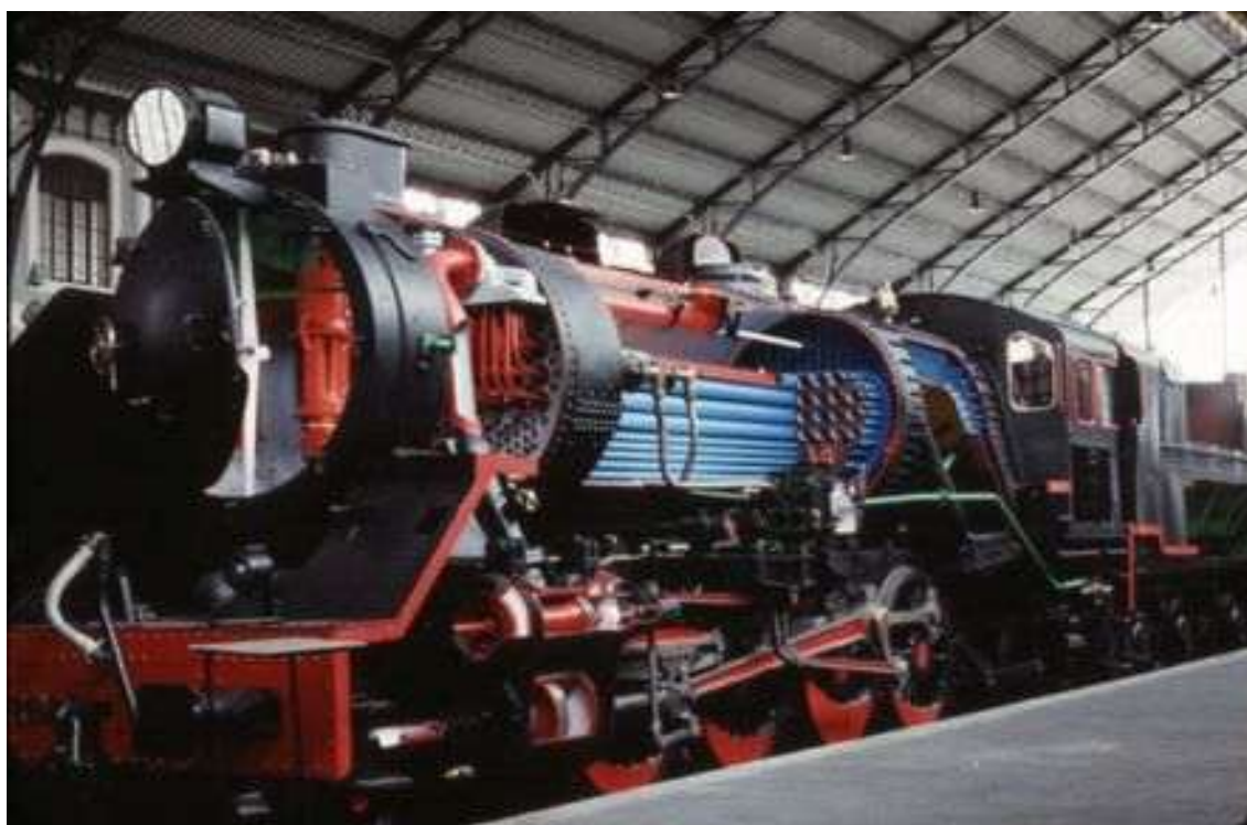
Locomotora de vapor 141-F-2416 MIKADO, construida por Euskalduna en Bilbao en 1960 y seccionada con fines didácticos en 1985. Museo del ferrocarril de Madrid. FFE
